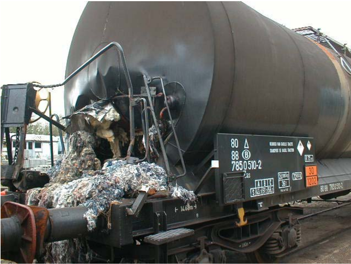
avarie (déchirure) de la citerne - photo prise après les opérations de déblaiement
