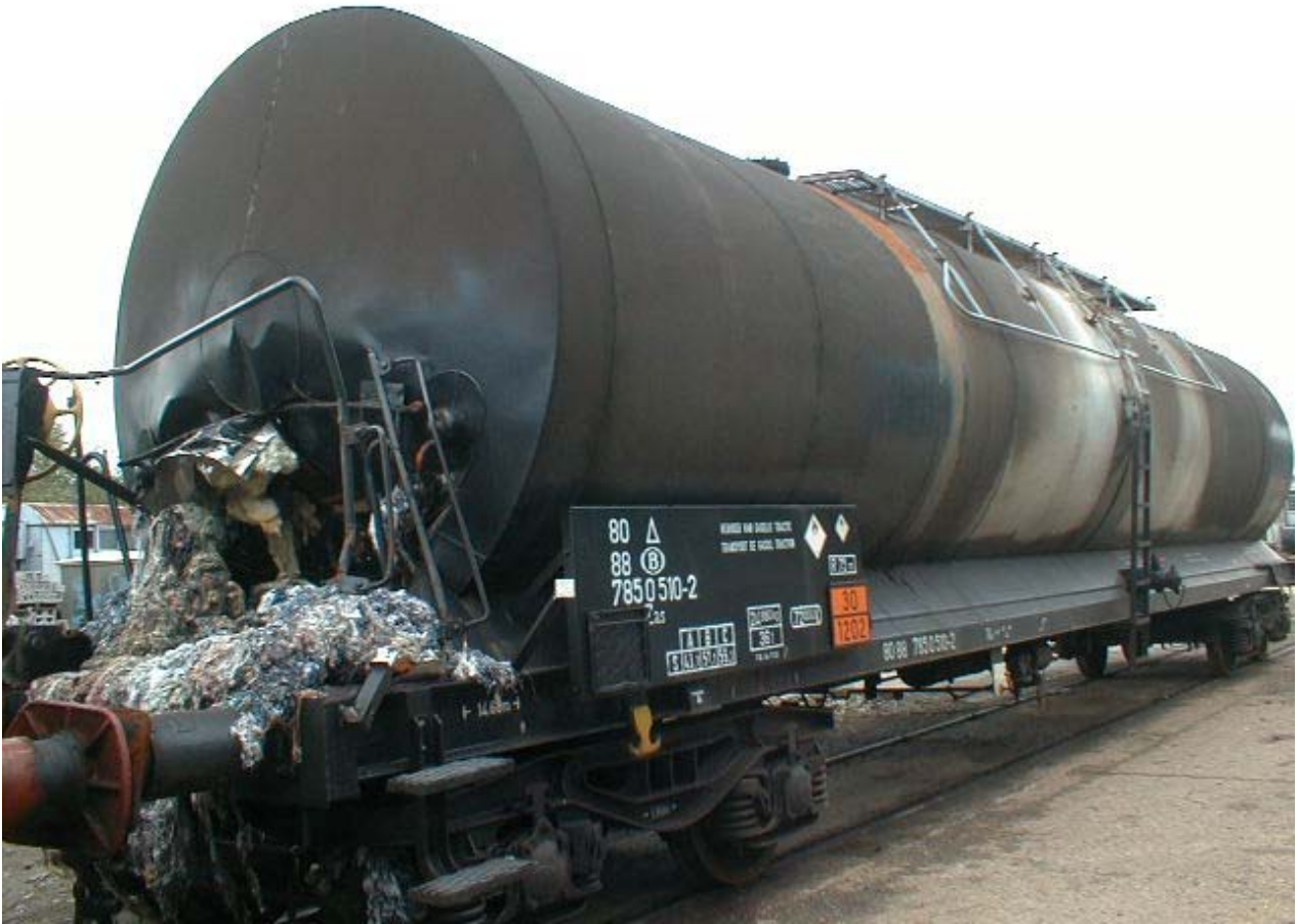
avarie (déchirure) de la citerne - photo prise après les opérations de déblaiement
