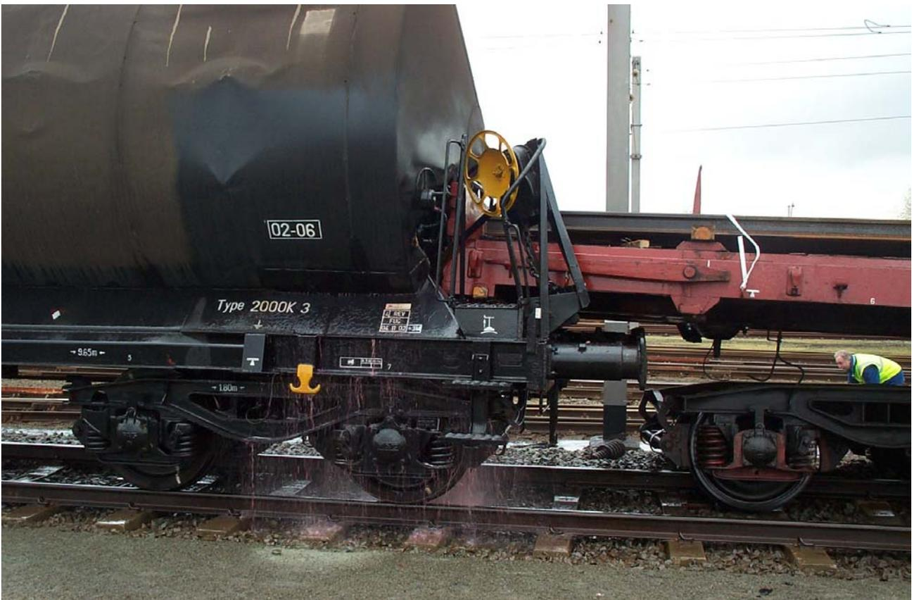
beschädigter Kesselwagen direkt nach dem Unfall
