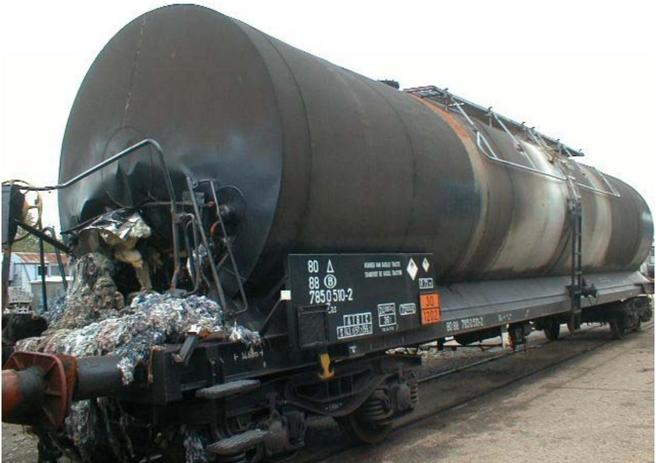
Beschädigung (Aufreißen) des Tanks (nach Abschluss der Aufräumarbeiten)
