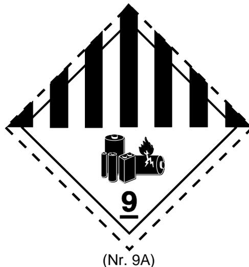
Symbol (sieben senkrechte Streifen in der oberen Hälfte; Ansammlung von Batterien, von denen eine beschädigt ist und Flammen entwickelt, in der unteren Hälfte): schwarz auf weißem Grund; unterstrichene Ziffer «9» in der unteren Ecke".
