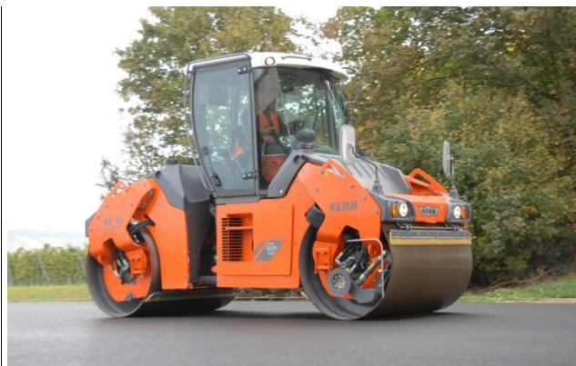
Tandemwalze im Einsatz
