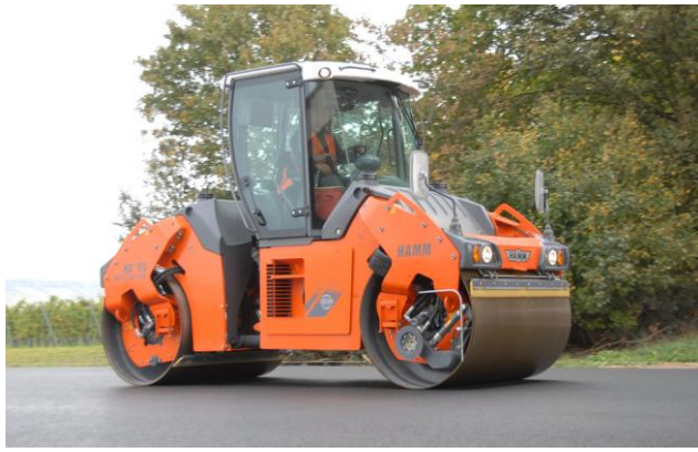
Tandemwalze im Einsatz
